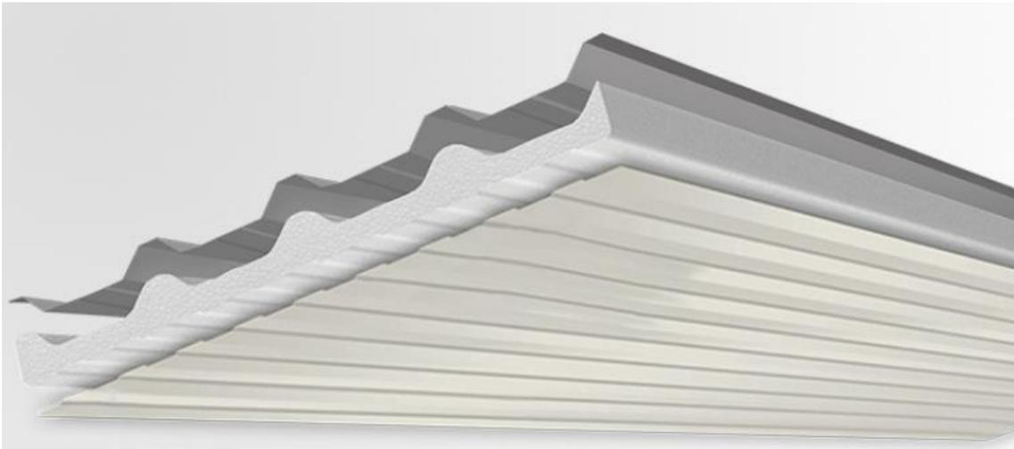
O sistema é constituído por telha superior no modelo trapézio preenchimento com o núcleo de EPS – Isopor e chapa inferior plana com pequenos frisos, como podemos ver no exemplo abaixo:
